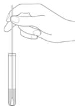
スティック受けの頂点を下向きにしたまま、スティック受けを に静かに入れます。このとき、スティック受けが底部に沈んでいることを確認し、沈んでいない場合はスティック受けを綿棒等で押し付けて沈めます。
