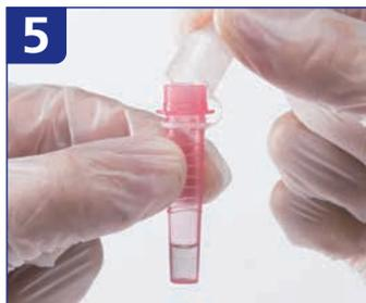
5 チューブに付帯のチップをかぶせるようにして装着する。装着が正しく行われた場合は、パチンと音がする。
