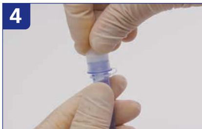
4 小分けチューブに付帯のチップをかぶせるようにして装着する。装着が正しく行われた場合は、パチンと音がする。
