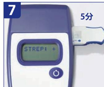
7 試料添加後5分経過したテストプレートをBD ベリター™ システム リーダーに挿入し、液晶画面に表示された測定結果を確認する。
