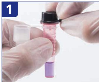
1 GAS試薬1、GAS試薬2及びテストプレートを用意する。GAS試薬2のフタを開ける際、片手でしっかり持ち、もう一方の手でフタを外す。
