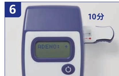
6 試料添加後10分間静置したテストプレートを、速やかにリーダーに挿入し、液晶画面に表示された判定結果を確認する。
