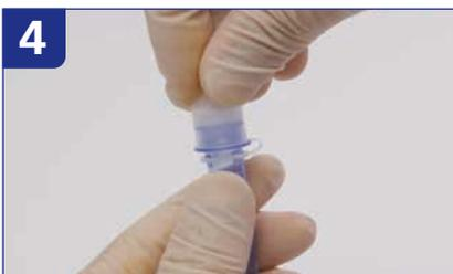
小分けチューブに付帯のチップをかぶせるようにして装着する。装着が正しく行われた場合は、パチンと音がする。
