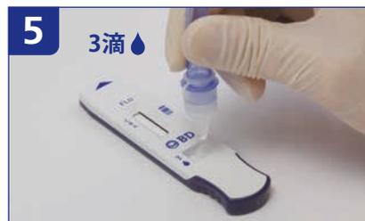
小分けチューブを逆さにして垂直に保持し、**チップの先端がテストプレートの試料滴下部へ触れないように注意**しながら試料を3滴添加し、その後5<sup>※1</sup>~10分間静置する。
