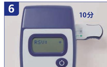
試料添加後10分間静置したテストプレートを、速やかにリーダーに挿入し、液晶画面に表示された測定結果を確認する。
