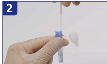
検体を採取した綿棒を小分けチューブに浸し、内壁に沿って3回転させる。
